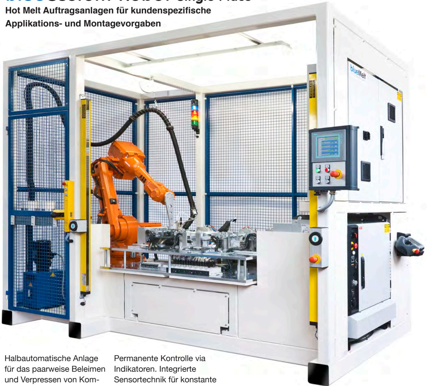
Halbautomatische Anlage für das paarweise Beleimen und Verpressen von Komponenten. Kurze Durchlaufzeit durch die Kombination mehrerer Arbeitsschritte mittels Roboter und pneumatischen Applikationen.
