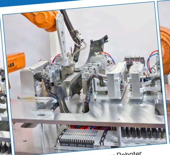
Auftrag des Klebers per Roboter
