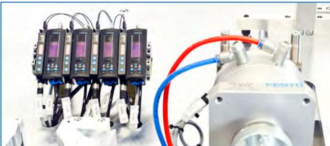
Bestückungskontrolle über Lichtwellenleiter und pneumatische Sensoren bei den Vakuumfixierungen
