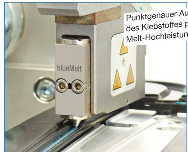
Punktgenauer Auftrag des Klebstoffes per blueMelt-Hochleistungskopf
