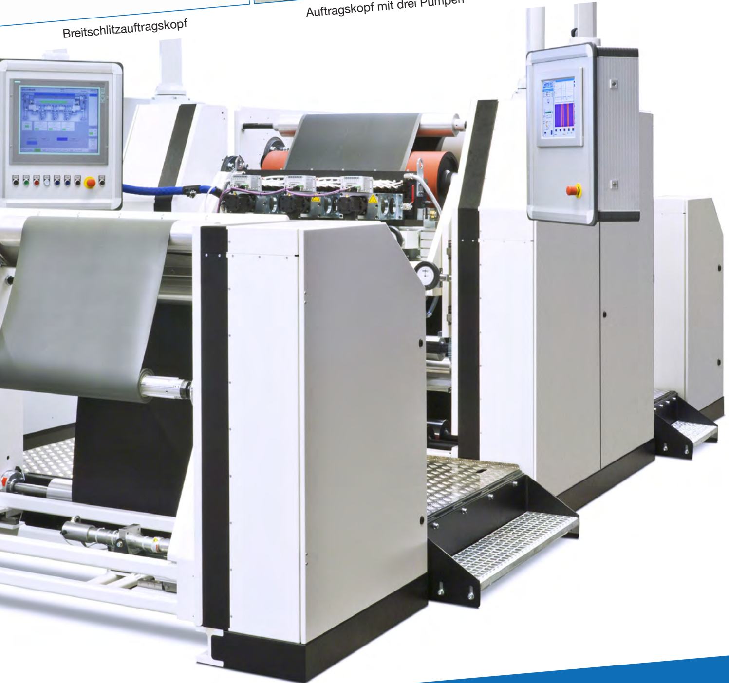
Thermografische Videokontrolle des Auftragsbildes
