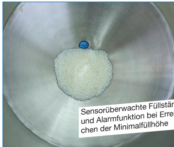
Sensorüberwachte Füllstände und Alarmfunktion bei Erreichen der Minimalfüllhöhe
