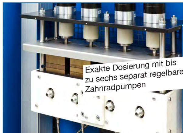
Exakte Dosierung mit bis zu sechs separat regelbaren Zahnradpumpen
