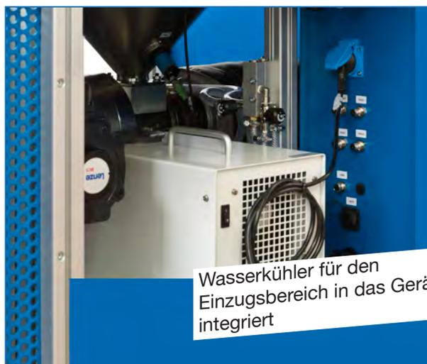
Wasserkühler für den Einzugsbereich in das Gerät integriert
