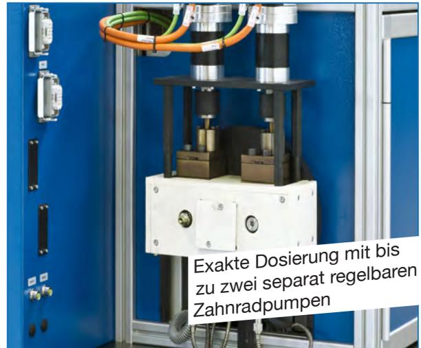
Exakte Dosierung mit bis zu zwei separat regelbaren Zahnradpumpen
