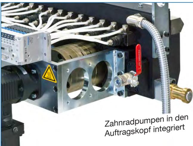
Zahnradpumpen in den Auftragskopf integriert
