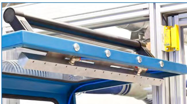
Trockenluftbegasung, um die Beschichtung mit reaktiven PUR-Klebstoffen zu ermöglichen
