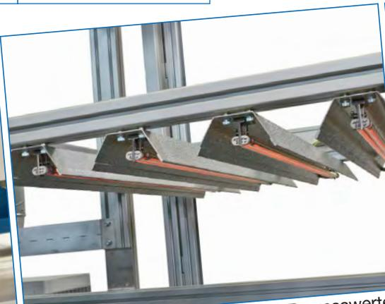
IR-Strecke zur Stabilisierung der Prozesswerte
