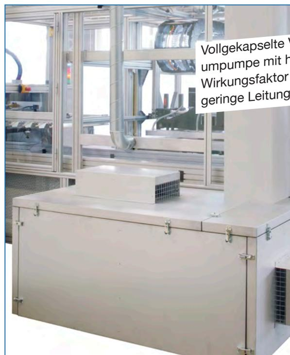
Vollgekapselte Vakuumpumpe mit hohem Wirkungsfaktor durch geringe Leitungslänge
