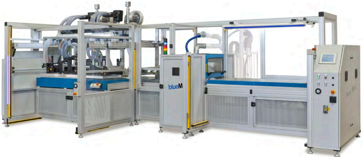
Halbautomatische Anlagen für das Belegen und Verpressen von Zuschnitten aus flexiblen Materialien. Kurze Durchlaufzeit und reproduzierbare Auftragsqualität durch die Kombination leistungsstarker Vakuum-
