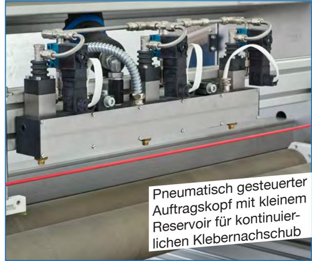
Pneumatisch gesteuerter Auftragskopf mit kleinem Reservoir für kontinuierlichen Klebernachschub
